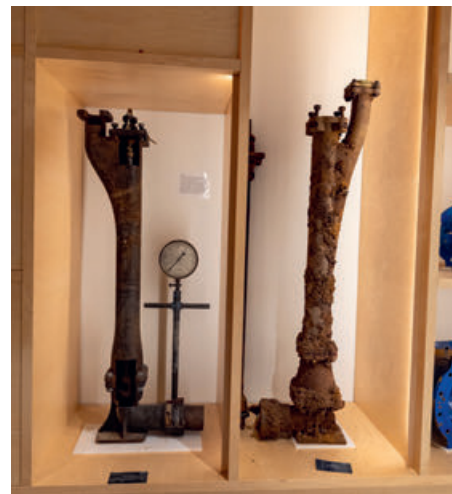
Två olika brandposter som Stockholm Vatten och Avfall har sparat när de plockats upp ur gatan. Den till vänster är från 50-60-talen, den till höger ännu äldre.
