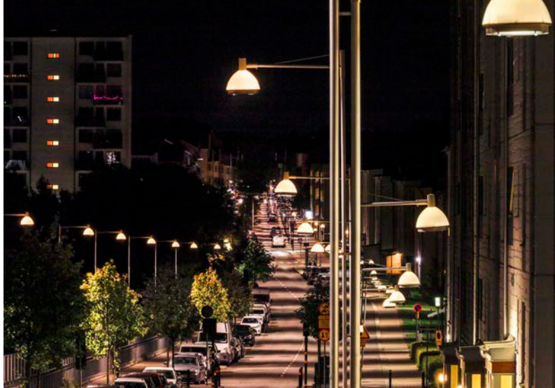
▲ Hägerstensvägen Gatubelysning gör gatorna säkrare och skapar trygghet. Oftast används varmvitt ljus och stolparna är målade för att ge en "omhändertagen känsla". Ytbehandlingen motverkar att zink kommer ut i naturen.
