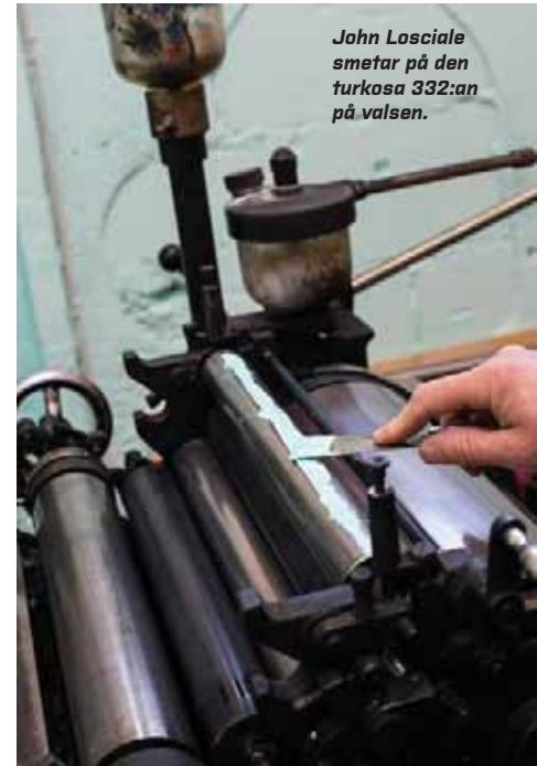
Korrekturpressen från Schweiz kan trycka format upp till 400 x 580 mm.
