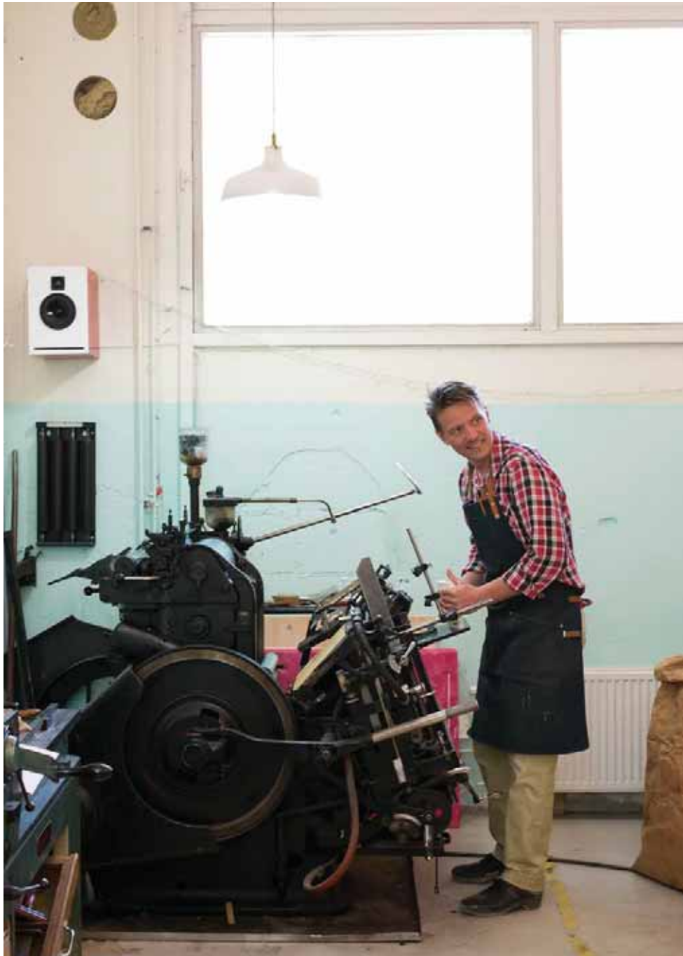
Korrekturpressen från Schweiz kan trycka format upp till 400 x 580 mm.
